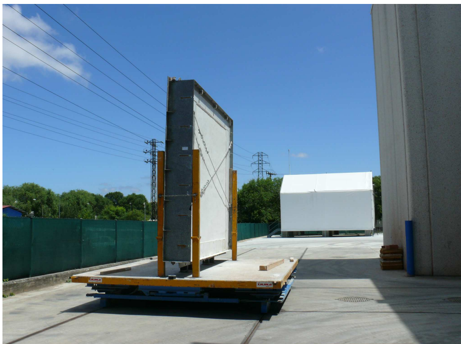
Figura 9 – Movimiento de la muestra hacia la célula de ensayos PASLINK
