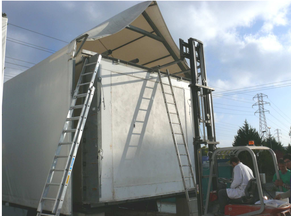
Figura 10 – Muestra montada en la célula de ensayos PASLINK
